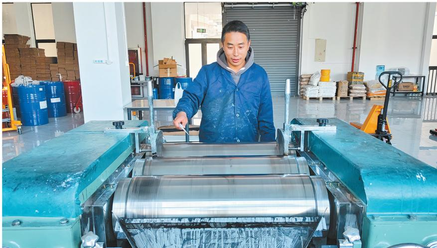
工作人员对分散细化研磨机器进行调试。
