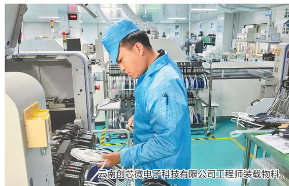
云南创芯微电子科技有限公司工程师装载物料。
